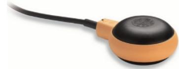
De dimensions réduites, il représente la solution la plus économique pour l'automatisation des électropompes et installations hydrauliques. Flotteur avec double chambre étanche résistant à la haute pression. Les petites dimensions et la grande force de flottabilité garantissent de hauts niveaux de performances. Optimal pour les applications lourdes et pour le contrôle du niveau dans des installations d'eaux noires et industrielles et pour les stations de relevage.
